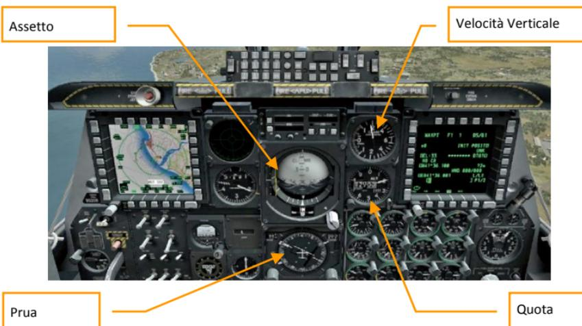
La rotta di volo è solitamente visualizzata su uno dei due Display a Colori Multi Funzione (MFCD) dell'abitacolo. Volate lungo la linea verde verso i vostri waypoint di navigazione o bersaglio.
