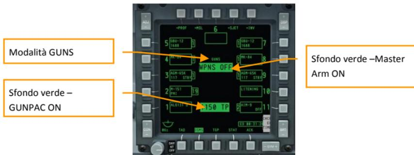
Selezionata la modalità GUNS, apparirà sull'HUD il reticolo di mira. Quando il bersaglio è a portata di tiro, una barra di distanza interna al reticolo inizierà ad avvolgersi in senso anti orario per indicare la distanza del bersaglio. Questa distanza viene visualizzata anche come valore direttamente sotto il reticolo.
