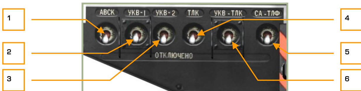
2-53: Pannello di controllo dell'alimentazione della Radio e Data Link
