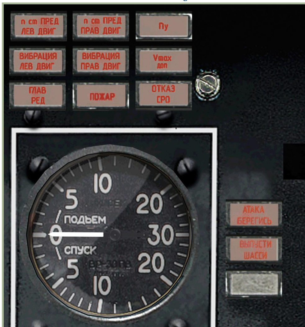
2-28: Pannello luci di avvertimento - Caution light panel
