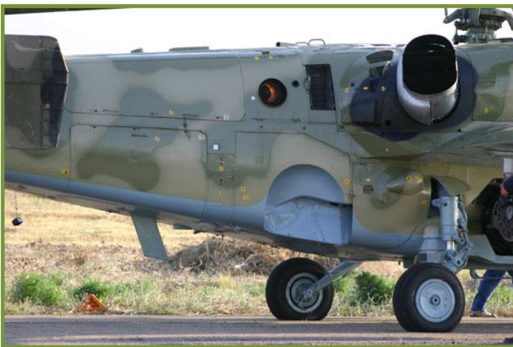
1-3: L'ugello di scarico del generatore ausiliario (in opera) ed i sistemi di schermatura degli scarichi del motore principale.
