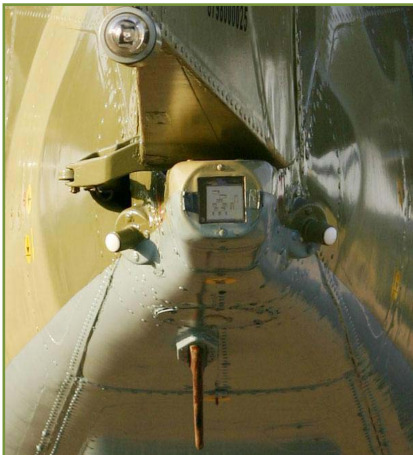
1-6: La coda del Ka-50. La luce di navigazione bianca si trova nella parte superiore dell'immagine. Il sistema di sensore laser L-140 laser si trova al centro ed ad ogni lato e sotto si trovano diverse antenne IFF
