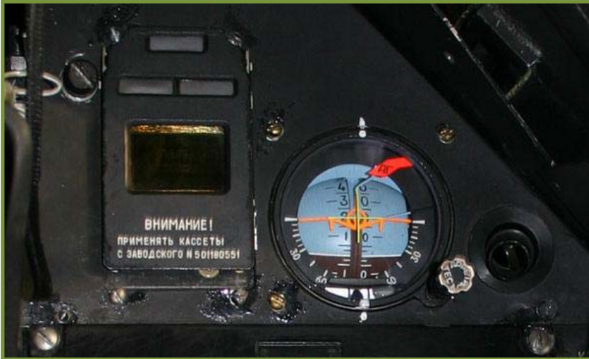
1-5: Il sistema di avvertimento e controllo interno all'Ekran (sinistra) e l'indicatore ausiliario di volo (destra) nel cockpit del Ka-50
