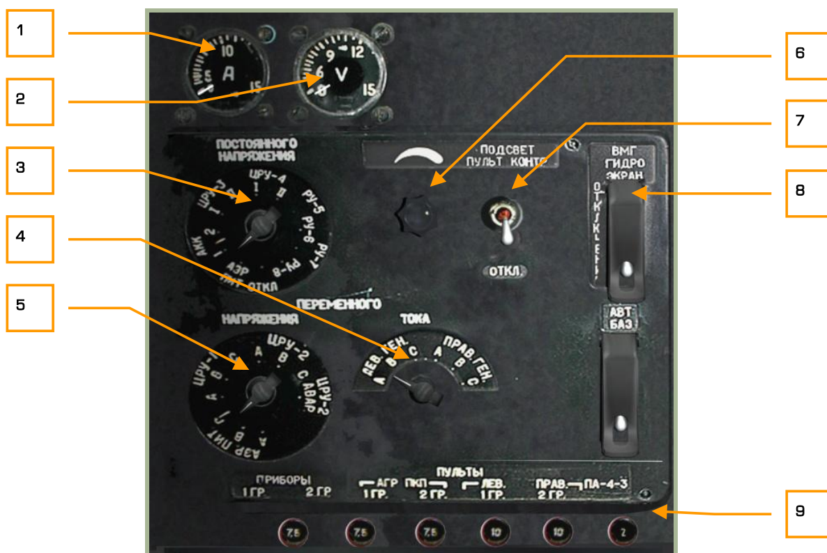
2-71: Pannello di controllo del sistema elettrico
