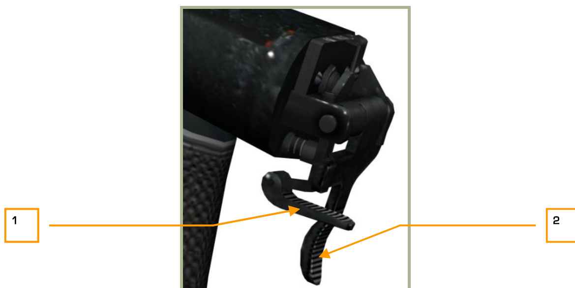
2-5: Grilletto per il rilascio dei carichi (grande) e cannone (small) nella posizione standard – Il rilascio dei carichi è operativo
